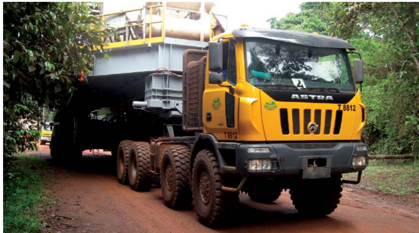
ТЯГАЧ 8X8 С КОРОБКЕЙ ПЕРЕДАЧ 165221 И WSK440 С ДОПОЛНИТЕЛЬНЫМИ СИСТЕМАМИ ОХЛАЖДЕНИЯ
