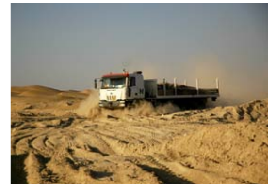
УДЛИНЕННАЯ ВЕРСИЯ ННД 6X6, ДЛИНА 6100 ММ, ДЛИННАЯ КАБИНА, КОРОБКА ПЕРЕДАЧ 165221, СИСТЕМА СПУСКА/ НАКАЧКИ ШИН, С УПРАВЛЕНИЕМ ИЗ КАБИНЫ WSK440
