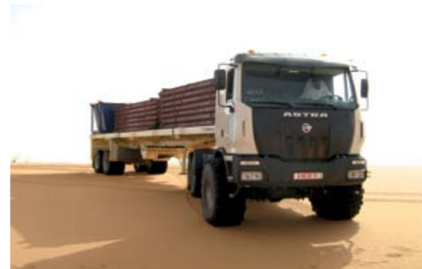
ТЯГАЧ 6X6, ВЕРСИЯ ДЛЯ ЭКСПЛУАТАЦИИ В ПУСТЫНЕ С ШИНАМИ ДЛЯ ЕЗДЫ ПО ПЕСКУ 24.00 R20.5
