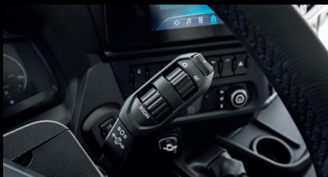
Devioguida completa di comando cambio automatizzato in posizione funzionale.
